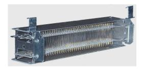
Un thermostat à réarmement par coupure de courant, dont la température de déclenchement est de 75°C; lorsque celle-ci est atteinte, une résistance type PTC est auto alimenté et empêche le ré enclenchement automatique de la batterie tant que celle-ci restera sous tension. Le ré enclenchement s'effectue par coupure de la tension d'alimentation de la batterie. Ce thermostat de sécurité protège l'appareil contre les surchauffes conséquentes en général à une absence de ventilation.
